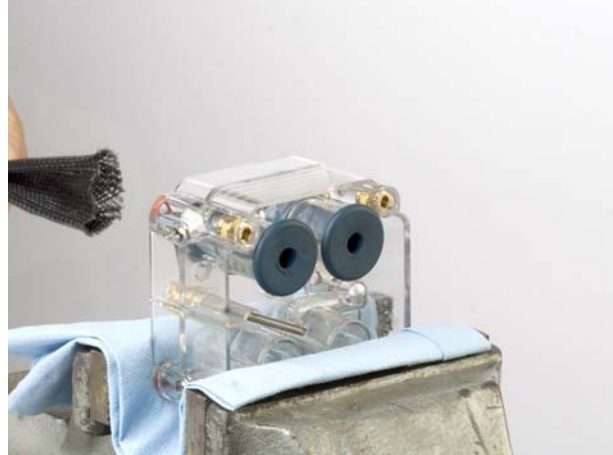
Afbeelding 16 Pinch valve door klephuis trekken
