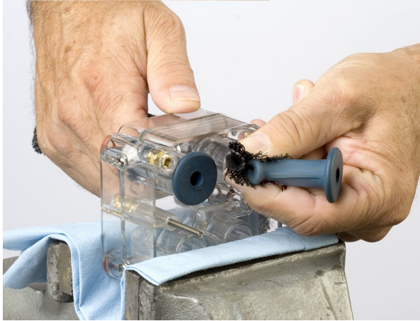
Kuva 14 Puristusventtiilin ylälaipan (UP) puristaminen litteäksi
