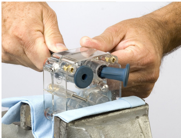
Kuva 15 Puristusventtiilin vetäminen venttiilirunkoon
