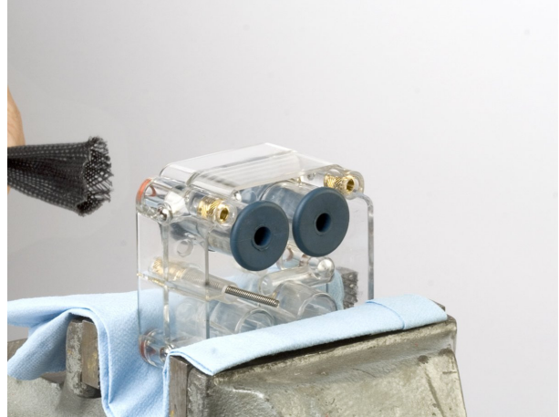
Kuva 16 Puristusventtiilin vetäminen venttiilirungon läpi
