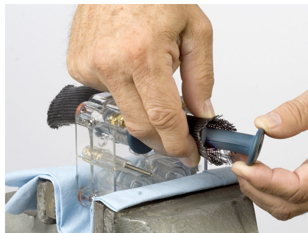
Kuva 13 Puristusventtiin asettaminen asennustyökaluun
