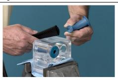
**NOTA:** Depois de ter colocado a válvula de manga flexível na ferramenta de inserção, aperte a extremidade superior da válvula.
