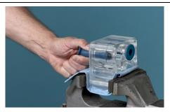
Puxe a válvula de manga flexível com força até ela sair do corpo de válvulas de manga flexível.
