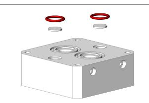
Retire da bomba os discos filtrantes antigos e as juntas tóricas antigas. Monte os discos filtrantes novos e as juntas tóricas novas incluídos no kit de válvulas de manga flexível.
