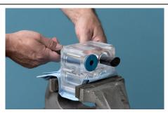
Rode o corpo de válvulas de manga flexível de modo que a extremidade superior fique voltada para si. Introduza a ferramenta de inserção de válvulas de manga flexível no corpo de válvulas de manga flexível.
