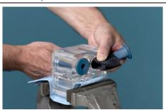
Introduza a extremidade superior da válvula de manga flexível na ferramenta de inserção de válvulas de manga flexível. Aperte a extremidade superior e introduza a extremidade pequena no corpo de válvulas de manga flexível.
