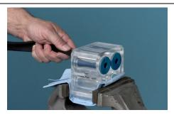
Puxe a ferramenta de inserção de válvulas de manga flexível com força, até a extremidade superior da válvula de manga flexível e a ferramenta de inserção completa saírem para fora da parte superior do corpo de válvulas de manga flexível.
