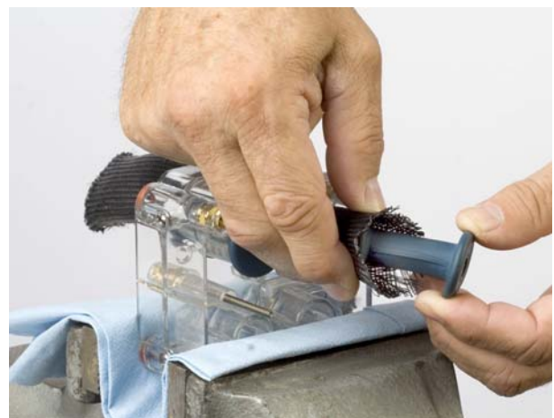
Kuva 13 Puristusventtiin asettaminen asennustyökaluun
