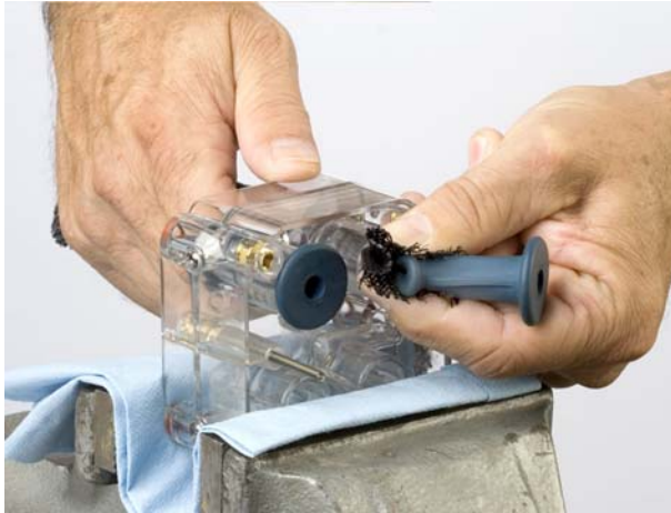
Kuva 14 Puristusventtiilin ylälaipan (UP) puristaminen litteäksi
