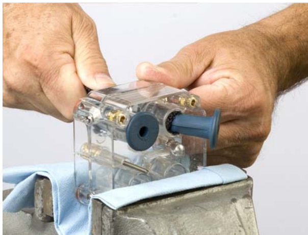
Kuva 15 Puristusventtiilin vetäminen venttiilirunkoon
