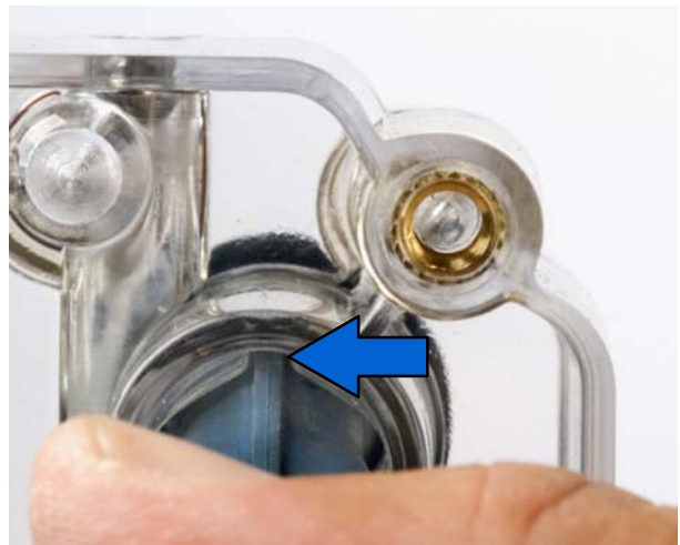
Kuva 17 Ripojen ja urien kohdistuksen tarkastus
