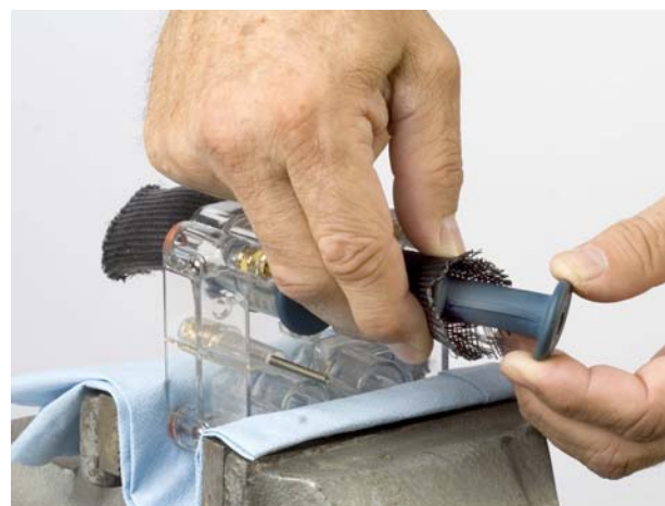
Figura 13 Inserção da válvula de manga flexível na ferramenta de inserção
