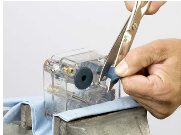
Figura 12 Remoção da válvula de manga flexível
