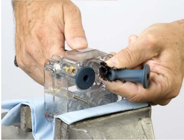
Figura 14 Aperto completo da flange UP da válvula de manga flexível
