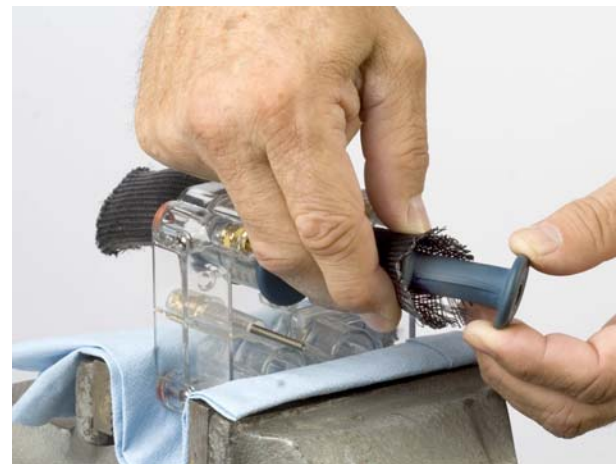
Figura 13 Inserção da válvula de manga flexível na ferramenta de inserção
