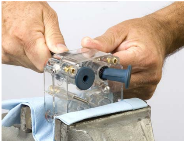
Figura 15 Puxar a válvula de manga flexível para dentro do corpo da válvula
