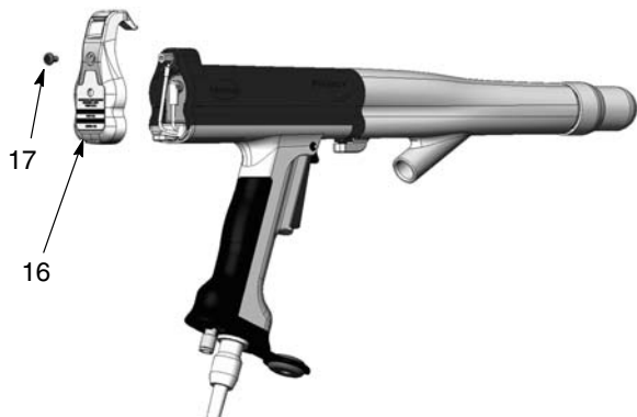
Figura 20 Remoção da tampa da extremidade
