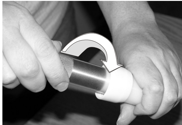
Fig. 7 Étape 2A du démontage de la buse
