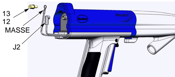
Fig. 21 Déconnexion du câble de commande
