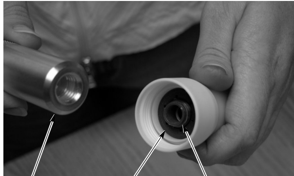
Outil Bague d'électrode Insert Fig. 6 Étape 1 du démontage de la buse (illustrée avec l'écrou monté)
