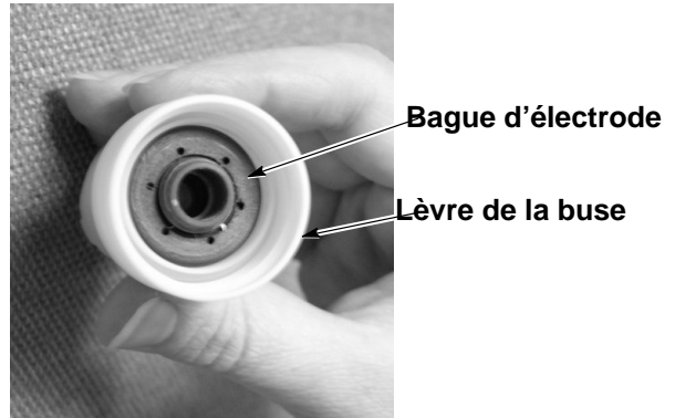
Fig. 10 Remontage de la buse
