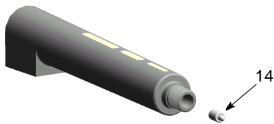
Fig. 28 Dépose de l'entretoise de contact
