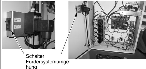
12. Den Netzschalter (14) an der Seite des Pumpenbedienfelds auf ON stellen. Falls der Schalter Fördersystemumgehung auf ON gestellt ist, schaltet sich der Vibrationsmotor ein.
