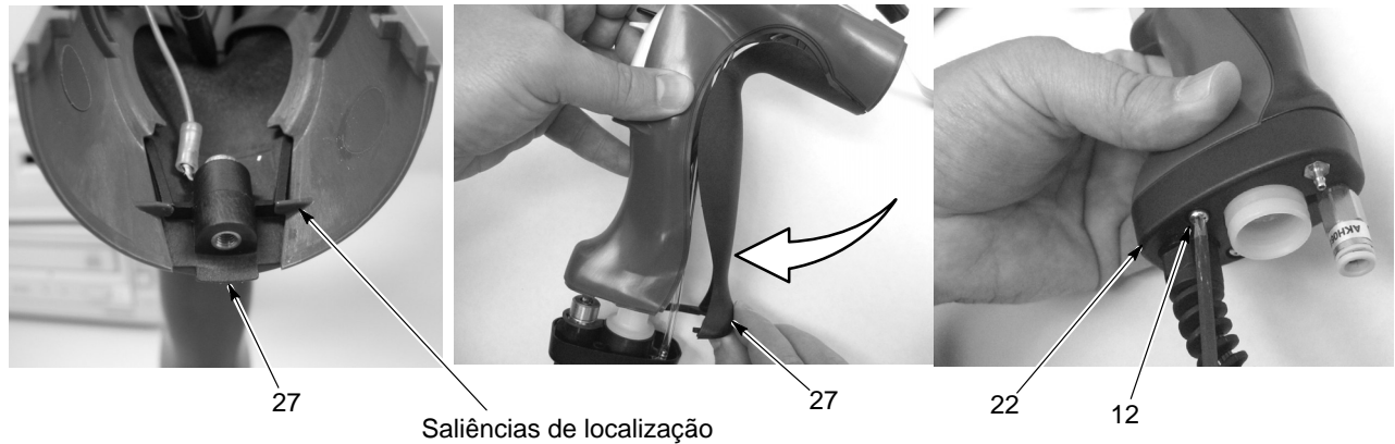
Figura 5-12 Montagem da parte traseira do punho e a base nos punhos
