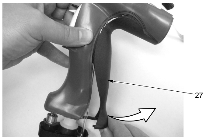
Figura 5-7 Remoção da parte traseira do punho
