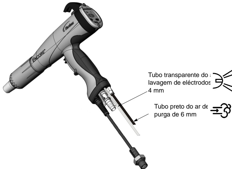
Figura 2-8 Ligação dos tubos de purga e de ar de lavagem à pistola para pintura
