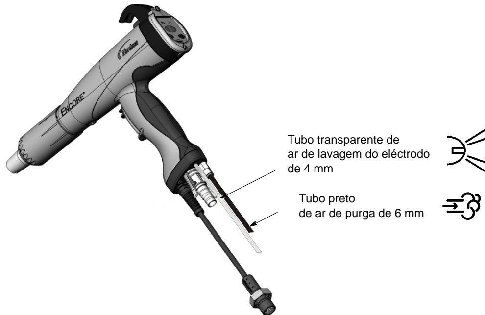
Figura 2-6 Ligação dos tubos de purga e de ar de lavagem à pistola para pintura
