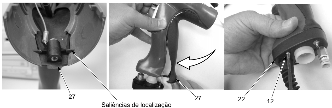
Figura 5-12 Montagem da parte traseira do punho e a base nos punhos
