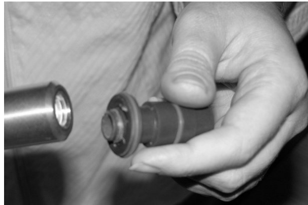
Kuva 11 Suuttimen purkaminen, vaihe 2B (kuvassa uudenmallinen suutin)
