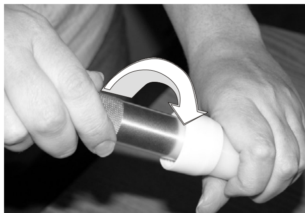
Kuva 9 Suuttimen purkaminen, vaihe 2A
