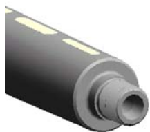
Kuva 33 Jännitteenkertojan syvennyksen rasvaus – putkikiinnitteinen puistooli
