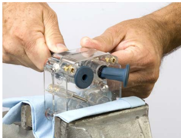
Figura 15 Inserción de la válvula peristáltica en el distribuidor de las válvulas
