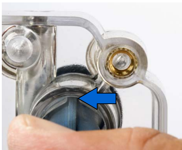
Figura 17 Comprobación de la alineación de los nervios y las ranuras
