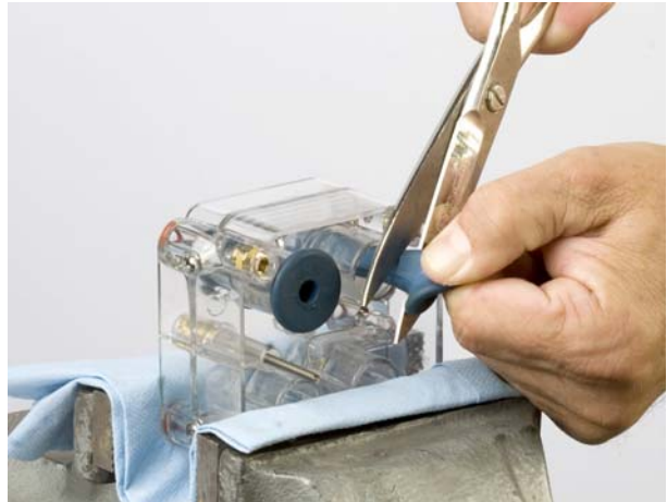
Figura 12 Extracción de las válvulas peristálticas
