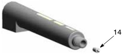
Figura 28 Extracción del separador de contacto
