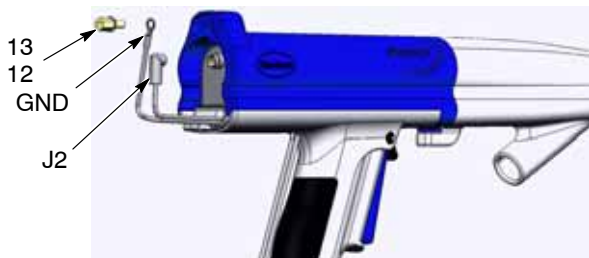
Figura 21 Desconexión del cable de control
