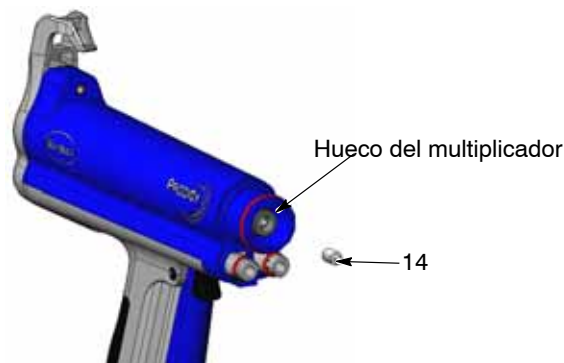
Figura 26 Extracción del separador de contacto
