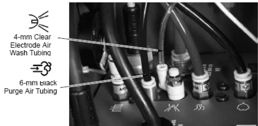
图 2-11 电极气洗管与吹扫空气管连至电源设备
