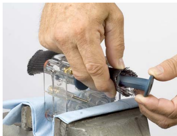
Rysunek 13 Wkładanie zaworu do narzędzia
