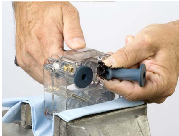
Rysunek 14 Ścisnięcie kołnierza zaworu z literami UP
