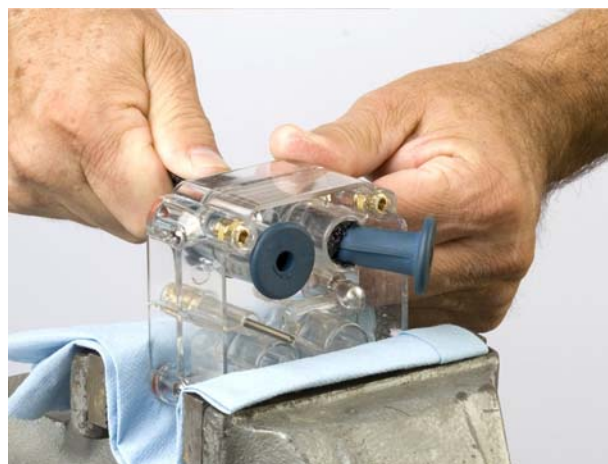
Rysunek 15 Wciąganie zaworu zaciskowego do komory
