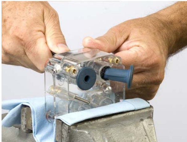
Rysunek 15 Wciąganie zaworu zaciskowego do komory.
