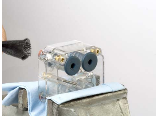
Rysunek 16 Przeciąganie zaworu zaciskowego przez komorę.
