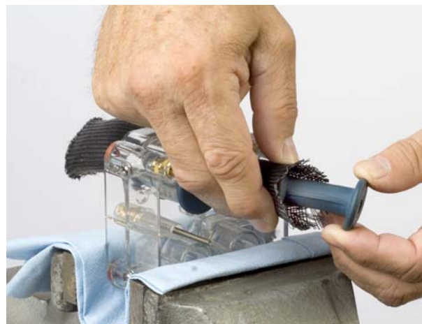
Rysunek 13 Wkładanie zaworu do narzędzia.
