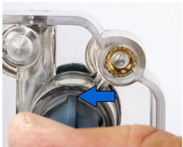
Rysunek 17 Sprawdzenie ustawienia występu i wgłębienia.
