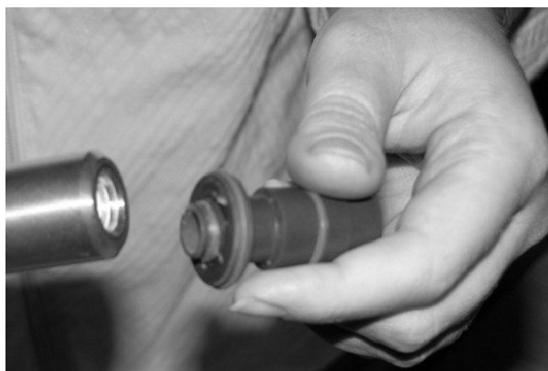
Rysunek 7 Etap 3 rozmontowywania dyszy (pokazano zespół nowego typu)
