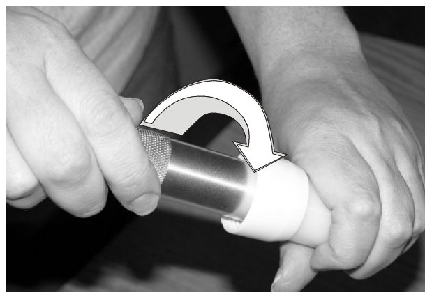
Rysunek 5 Etap 2A rozmontowywania dyszy.
