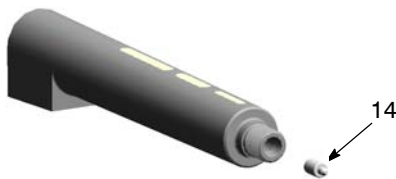
Fig. 28 Rimozione del distanziatore a contatto
