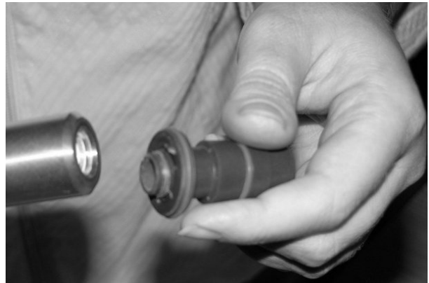
Fig. 9 Smontaggio dell'ugello – Punto 3 (nell'illustrazione il nuovo tipo)
