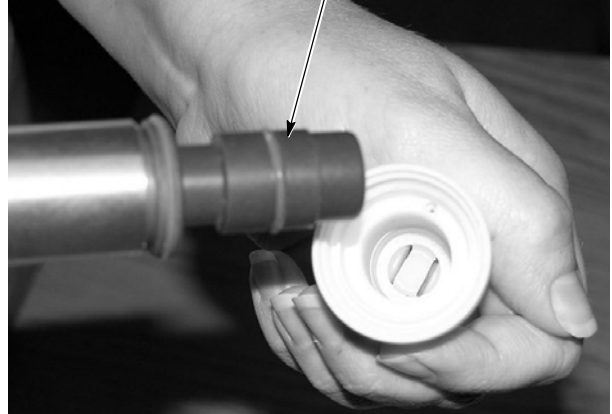
Fig. 8 Smontaggio dell'ugello – Punto 2B (nell'illustrazione il nuovo tipo di gruppo)
