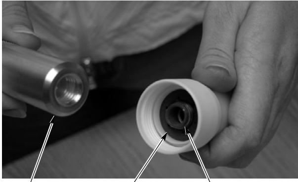
Utensile Anello dell'elettrodo Tassello Fig. 6 Smontaggio dell'ugello – Punto 1 (nell'illustrazione con dado installato)
