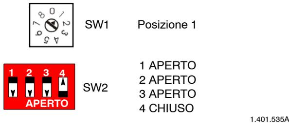
Fig. 4 Impostazioni SW1 e SW2 per sistemi manuali di spruzzo polvere
