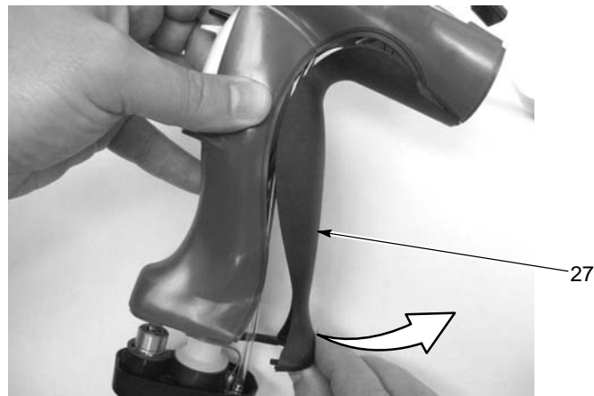
Fig. 5-8 Extracción del acolchado
