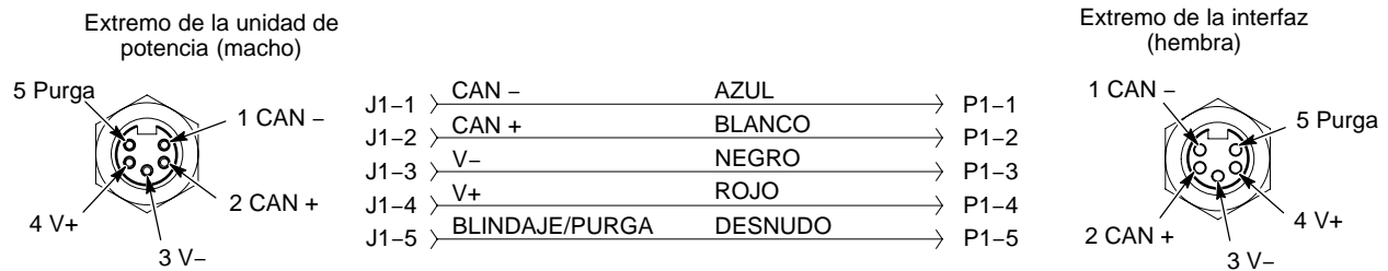
Fig. 4-5 Conexión eléctrica del cable de interconexión del controlador
