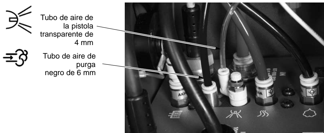
Fig. 2-9 Conexión de los tubos del aire de la pistola y del aire de purga al controlador
