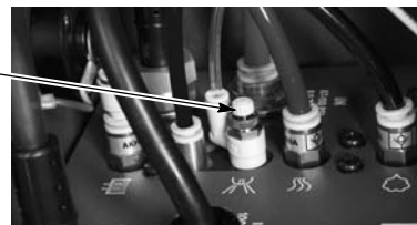
Fig. 3-3 Localización de la válvula de aguja para la limpieza de aire de electrodos
