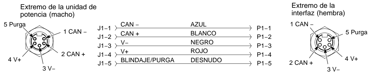
Fig. 4-5 Conexión eléctrica del cable de interconexión del controlador
