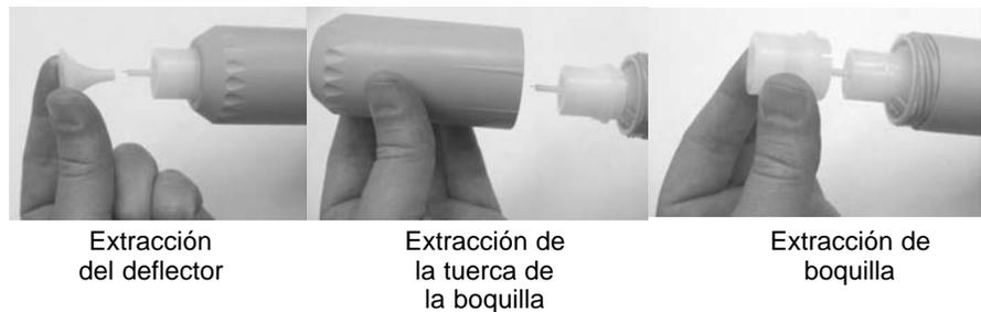
Fig. 3-5 Cambio de deflectores y boquillas cónicas
