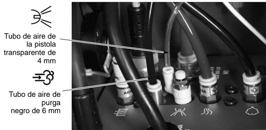
Fig. 2-11 Conexión de los tubos de limpieza de aire de electrodos y del aire de purga a la unidad de potencia
