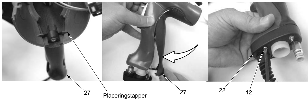
Fig. 5-12 Montering af jordforbindelsesdelen og underdelen på pistolgrebene
