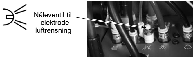
Fig. 3-3 Placering af nåleventil til elektrodeluftrensning
