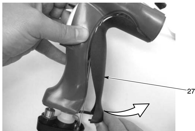
Fig. 5-8 Aftagning af jordforbindelsesdelen
