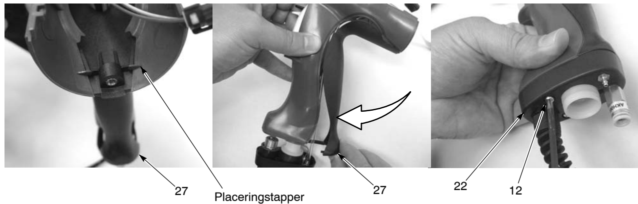
Fig. 5-12 Montering af jordforbindelsesdelen og underdelen på pistolgrebene
