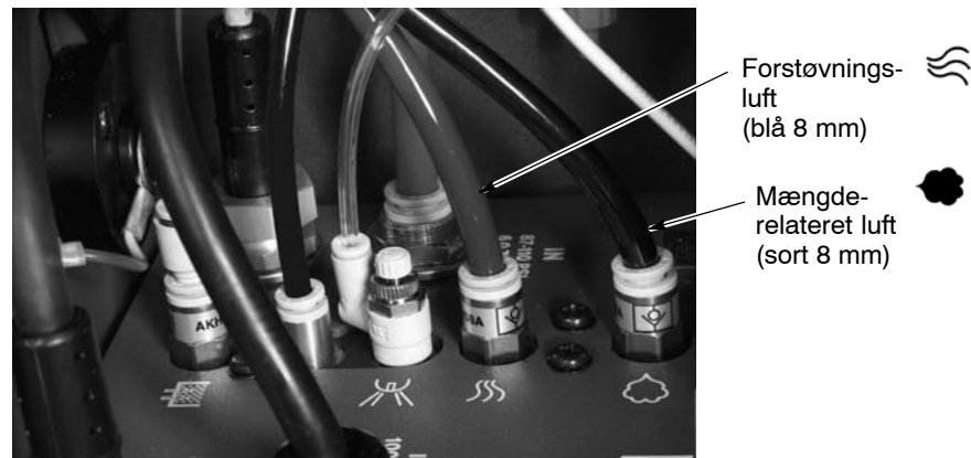
Fig. 2-9 Tilslutning af den mængderelaterede luftslange og forstøvningsluftslangen til strømenheden
