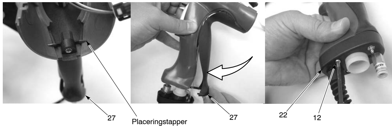
Fig. 5-12 Montering af jordforbindelsesdelen og underdelen på pistolgrebene
