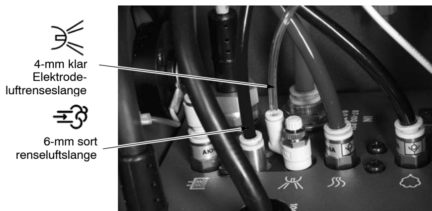
Fig. 2-11 Tilslutning af elektrodeluftrensning og renseluftslanger til strømenheden
