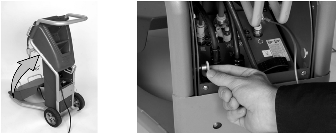
Kuva 2-5 Vaunun kädensijan aukitaittaminen ja kiinnittäminen
