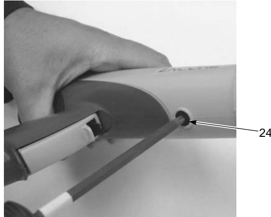
Kuva 5-5 Pistoolin rungon ruuvin irrotus
