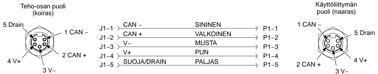
Kuva 4-5 Ohjausyksikön välikaapelin testaus
