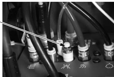
Kuva 3-4 Siirrettävän järjestelmän leijutusilman ohjaus
