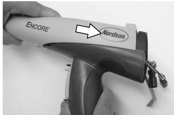
Kuva 5-14 Pulverin ulostuloputken asennus
