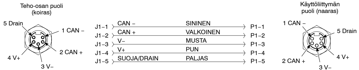
Kuva 4-5 Ohjausyksikön välikaapelin testaus
