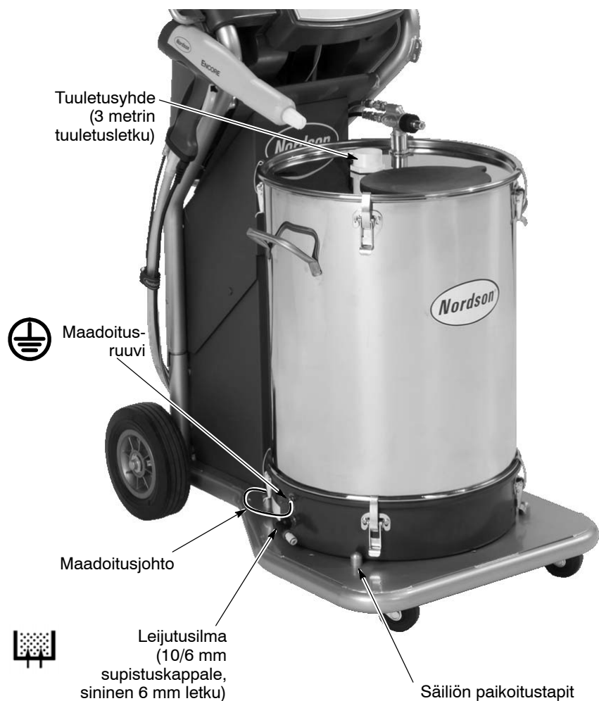
Kuva 2-6 Syöttösäiliön asennus
