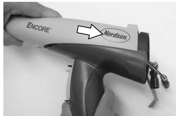
Kuva 5-14 Pulverin ulostuloputken asennus
