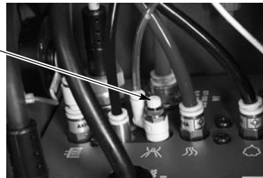
Kuva 3-3 Elektrodi ilmapuhdistuksen venttiilin sijainti
