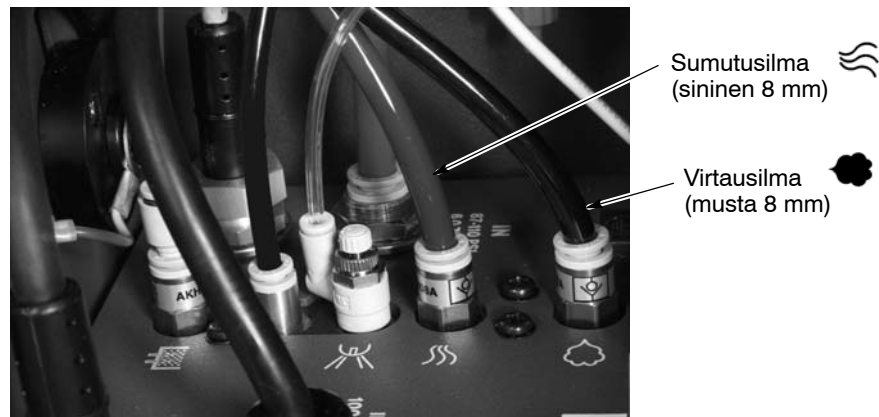
Kuva 2-9 Virtaus- ja sumutusilmaletkujen liitännät teho-osaan
