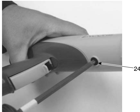
Kuva 5-5 Pistoolin rungon ruuvin irrotus
