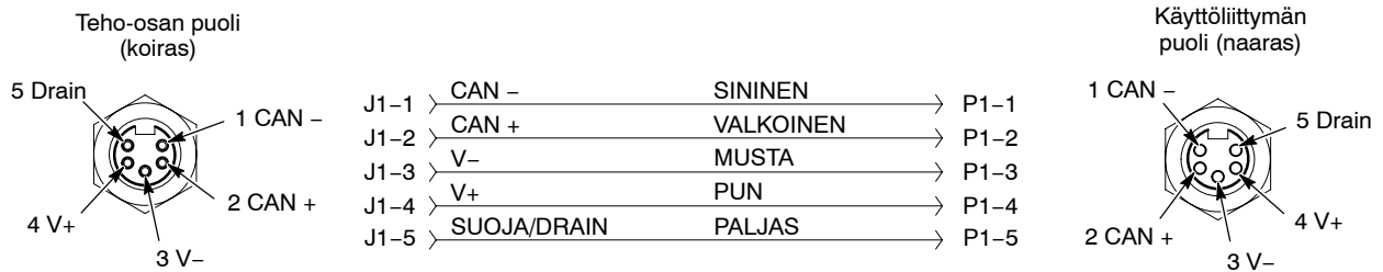
Kuva 4-5 Ohjausyksikön välikaapelin testaus
