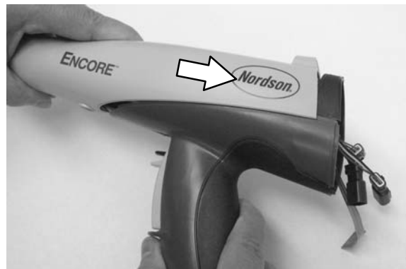
Kuva 5-14 Pulverin ulostuloputken asennus
