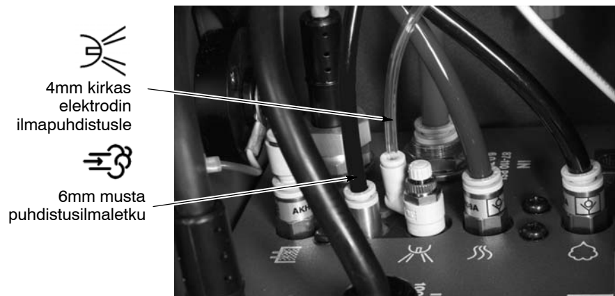
Kuva 2-11 Elektrodin ilmapuhdistus- ja puhdistusilmaletkujen kytkeminen teho-osaan
