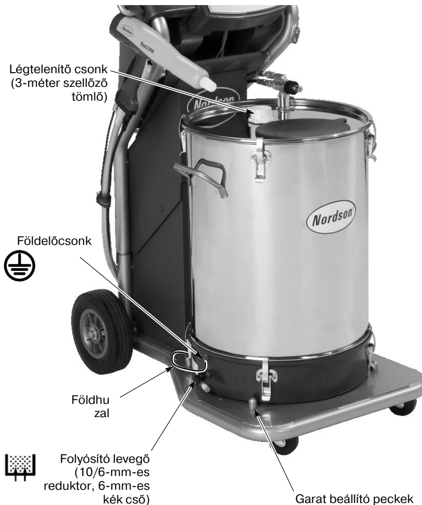
Ábra 2-6 Garat beszerelése
