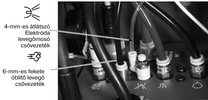
Ábra 2-11 Az elektróda levegőmosó és öblítő csővezeték csatlakoztatása a tápegységre
