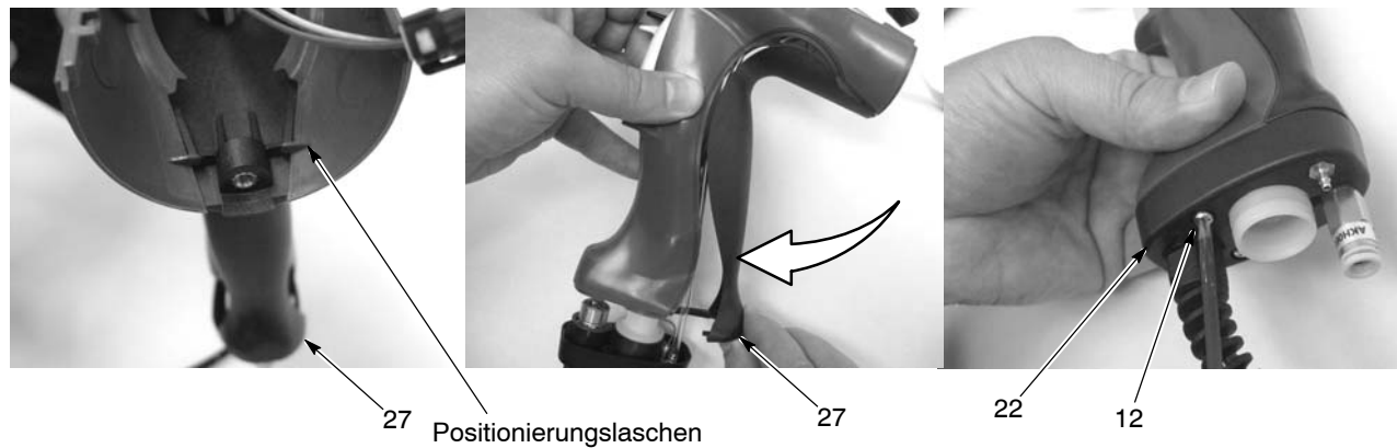
Abb. 5-12 Erdungsstück und Basis an Griffhälften anbringen
