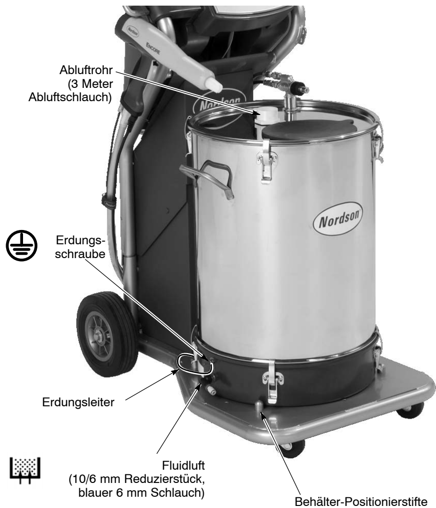
Abb. 2-6 Pulvervorratsbehälter installieren
