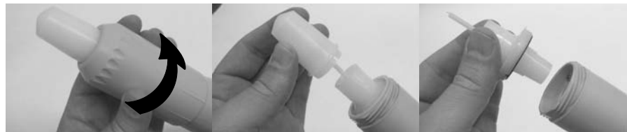
Düsenmutter abnehmen Flachsprühdüse abnehmen Elektrode installieren
