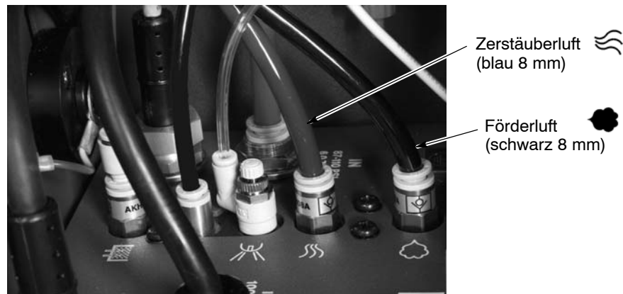
Abb. 2-9 Anschlüsse für Förderluft und Zerstäuberluft am Spannungsversorgungsmodul
