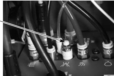
Abb. 3-3 Lage des Elektrodenspülluftventils
