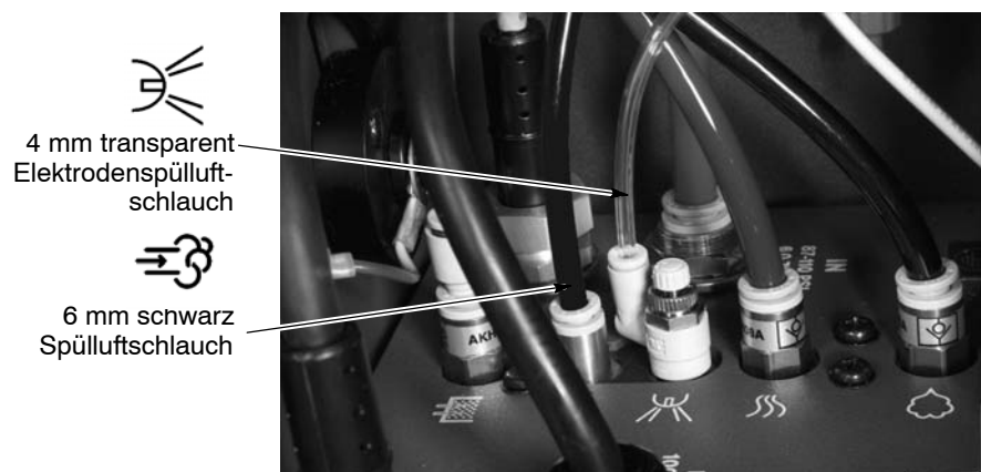
Abb. 2-11 Elektrodenspülluft- und Spülluftschlauch an das Spannungsversorgungsmodul anschließen
