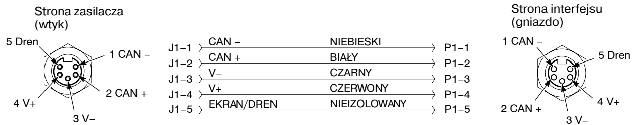
Rysunek 4-5 Test kabli połączeniowych sterownika
