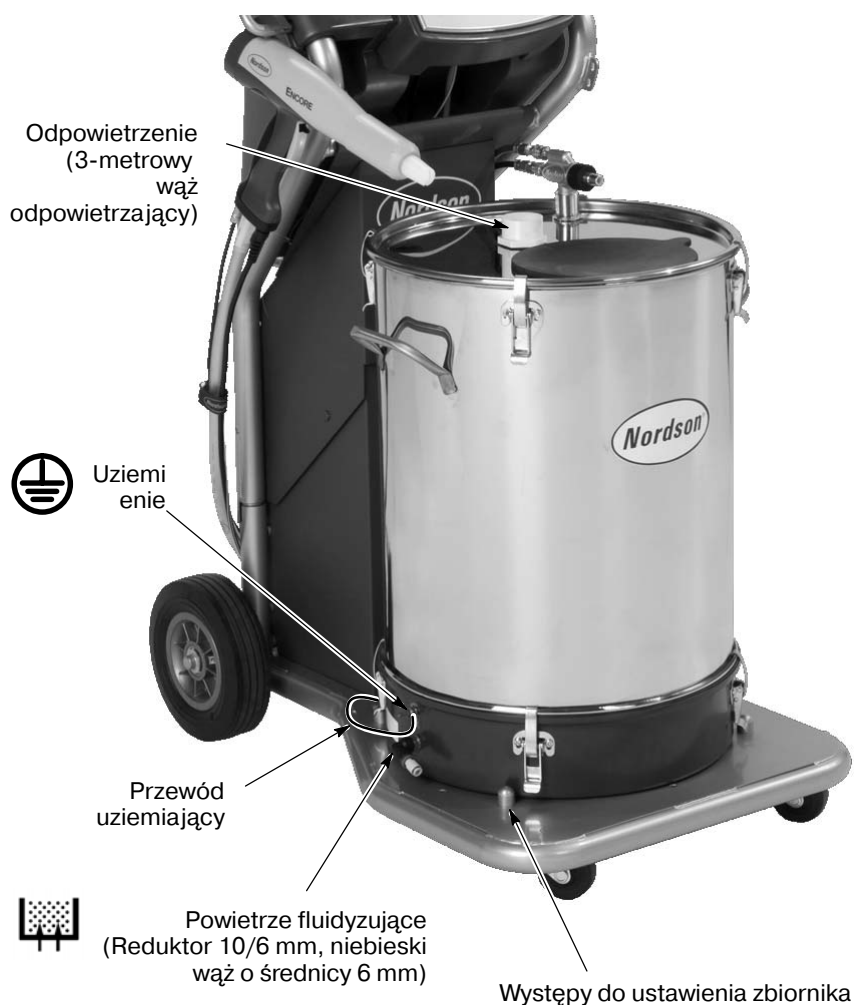
Rysunek 2-6 Instalacja zbiornika.
