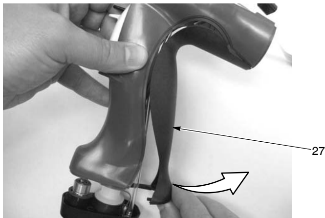
Rysunek 5-8 Zdejmowanie płytki uziemiającej.
