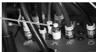
Rysunek 3-3 Lokalizacja zaworu igłowego powietrza do odmuchu elektrody
