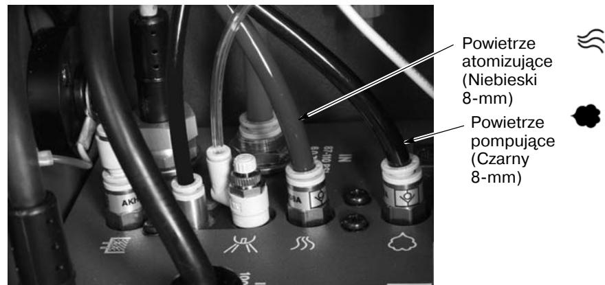
Rysunek 2-9 Podłączenie węży powietrza pompującego i atomizującego do zasilacza.
