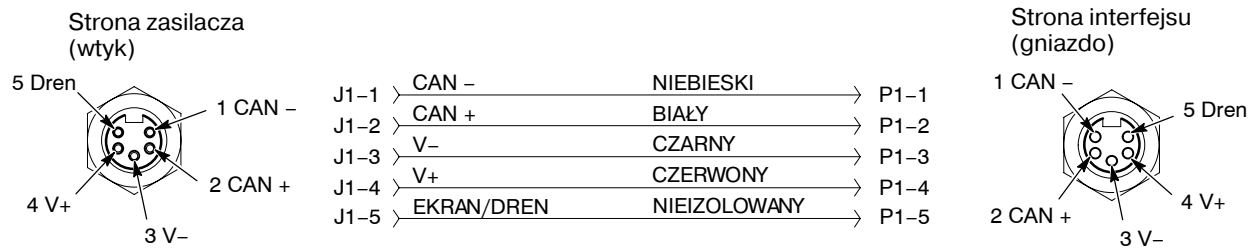
Rysunek 4-5 Test kabli połączeniowych sterownika
