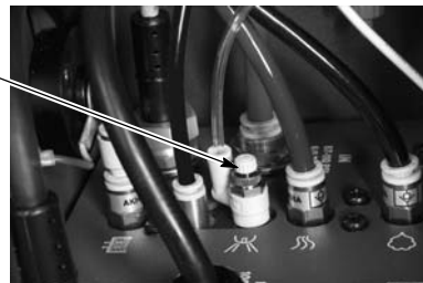
Afb. 3-4 Regeling fluïdisatielucht bij mobiel systeem
