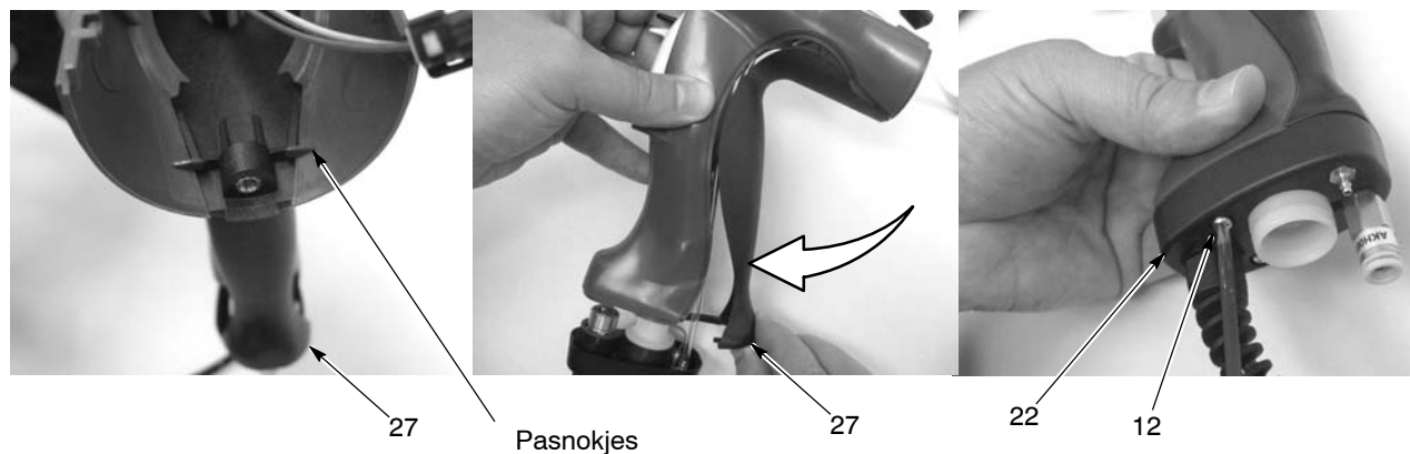
Afb. 5-12 Aardingsgreep en benedenstuk monteren aan greephelften
