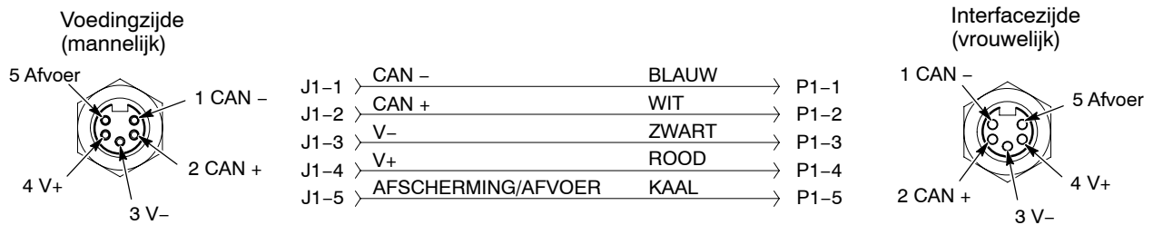
Afb. 4-5 Aders in verbindingkabel besturing
