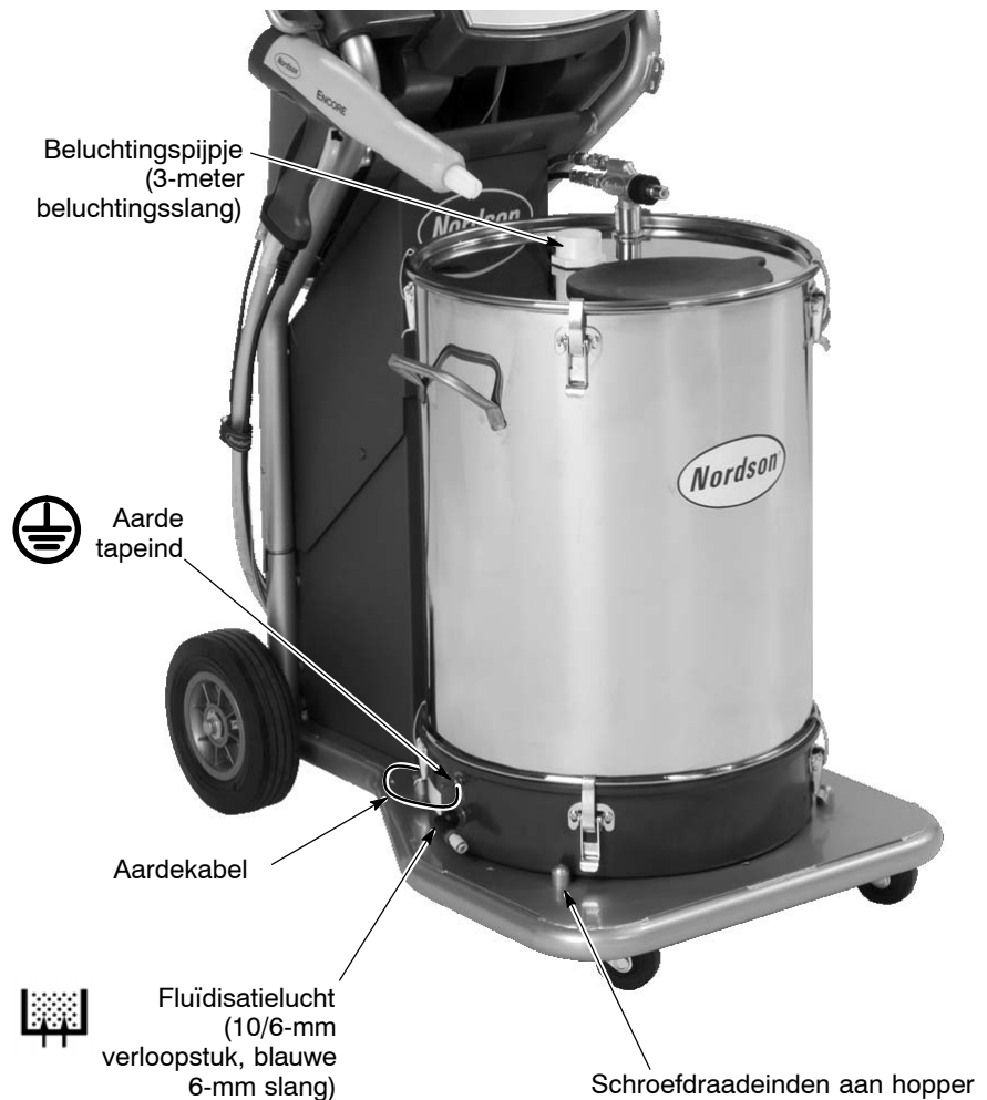
Afb. 2-6 Installeren van de hopper
