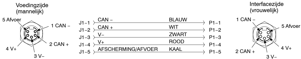
Afb. 4-5 Aders in verbindingkabel besturing
