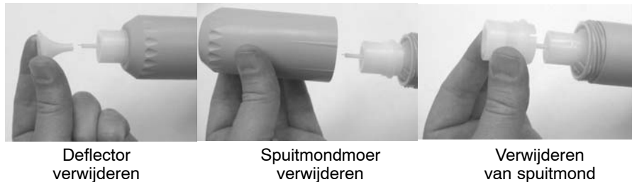
Afb. 3-5 Deflectors en conische spuitmondten wisselen
