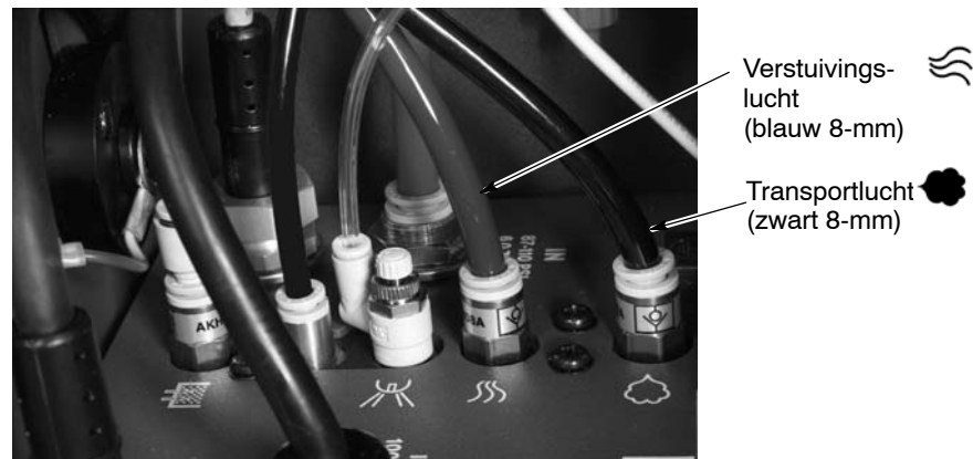
Afb. 2-9 Aansluitingen aan voedingseenheid voor transportlucht en verstuivingslucht
