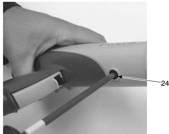
Afb. 5-5 Schroef in pistoolhuis verwijderen
