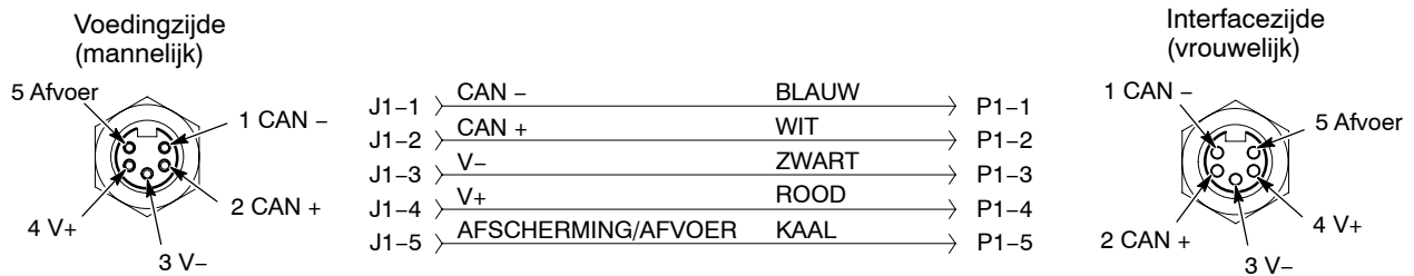
Afb. 4-5 Aders in verbindingkabel besturing
