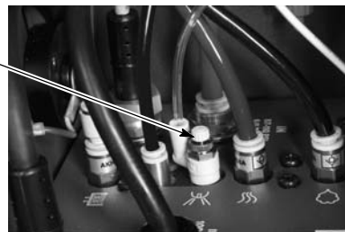
Fig. 3-4 Commande d'air de fluidisation du système mobile
