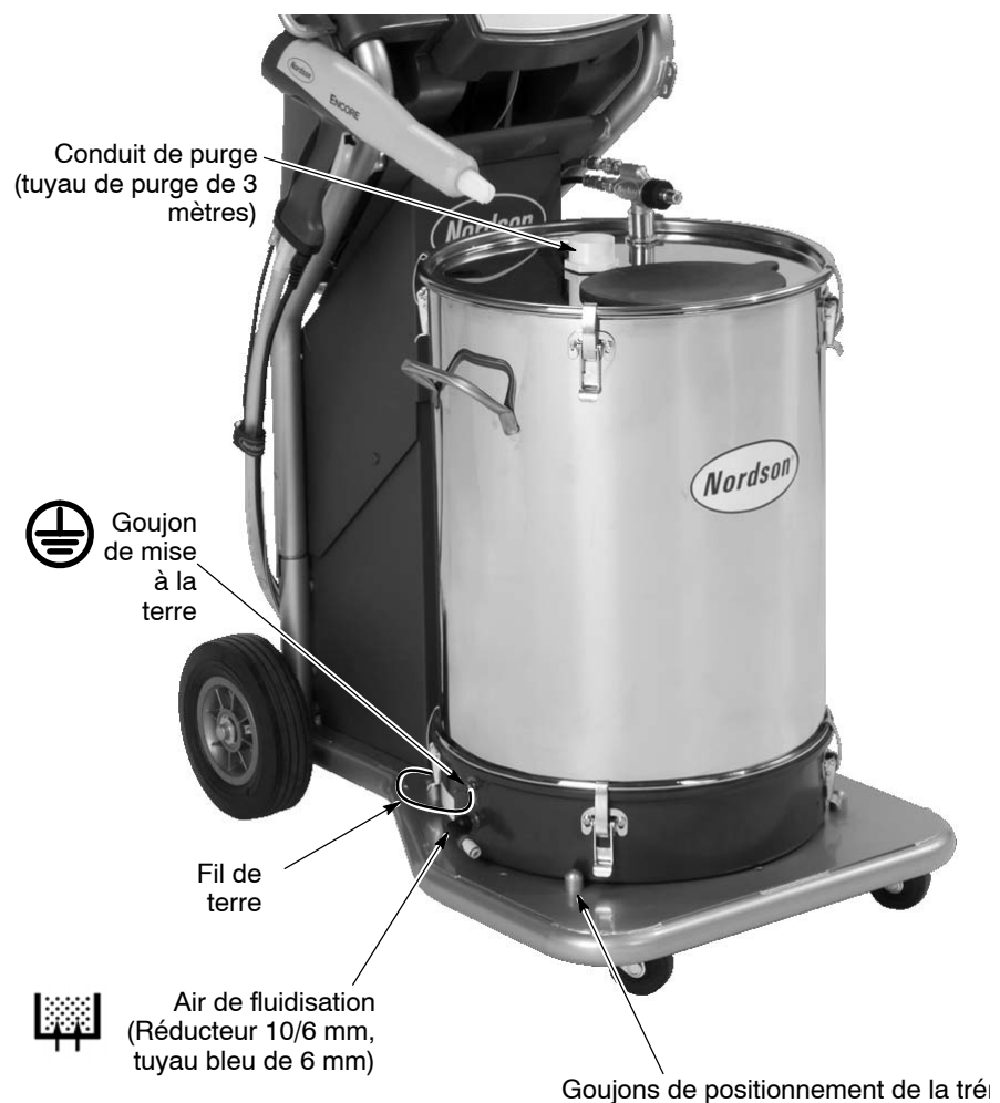
Fig. 2-6 Installation de la trémie
