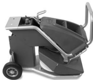
Position de transport repliée (système VBF (Dispositif d'alimentation vibrant) illustré)
