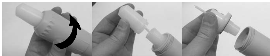
Dépose de l'écrou de la buse
