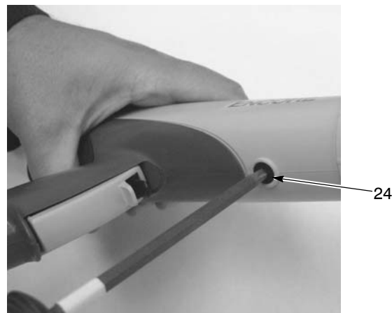
Fig. 5-5 Dépose de la vis du corps du pistolet
