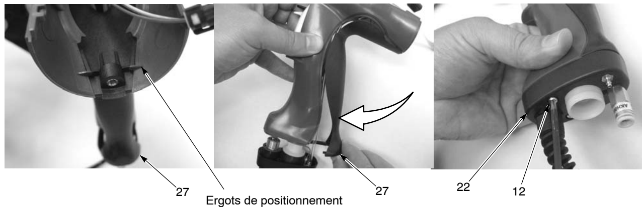
Fig. 5-12 Montage de la pastille de terre et de la base sur les demies-poignées
