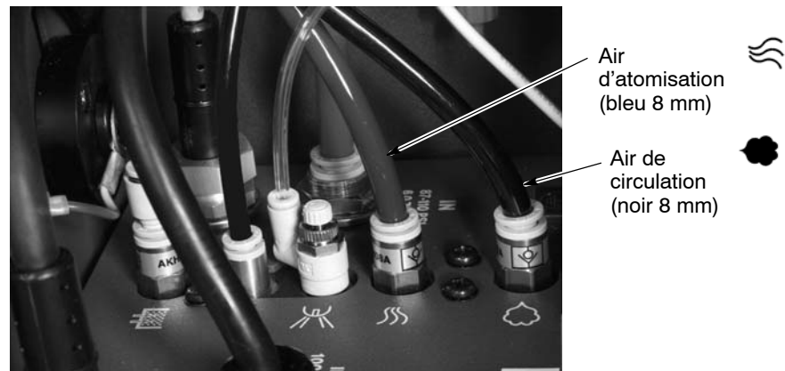
Fig. 2-9 Raccordement des tuyaux à air de circulation et d'atomisation au bloc d'atomisation
