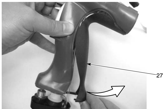
Fig. 5-8 Dépose de la pastille de terre
