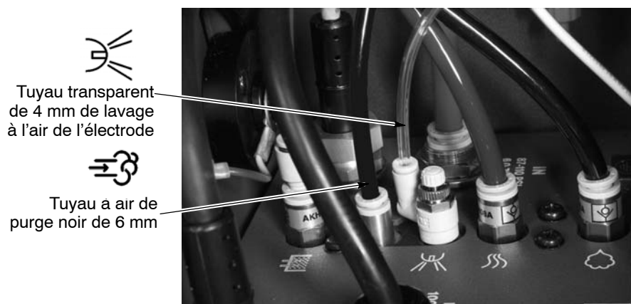
Fig. 2-11 Raccordement des tuyaux de lavage à l'air de l'électrode et à air de purge au bloc d'alimentation
