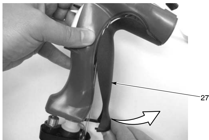
Bild 5-8 Demontering av jordad handtagsdel
