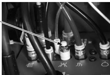
Bild 3-4 Styrning av fluidiseringsluften i ett flyttbart system.
