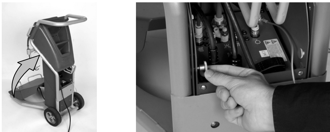
Bild 2-5 Uppfällning av handtag och fastsättning i läge
