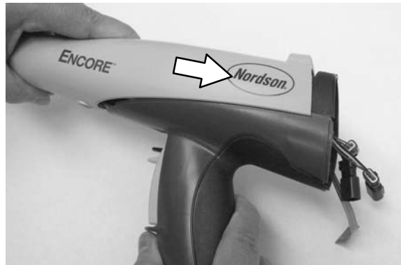
Bild 5-14 Montering av utgångsrör för pulver
