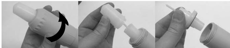
Demontering av munstycksmutter
