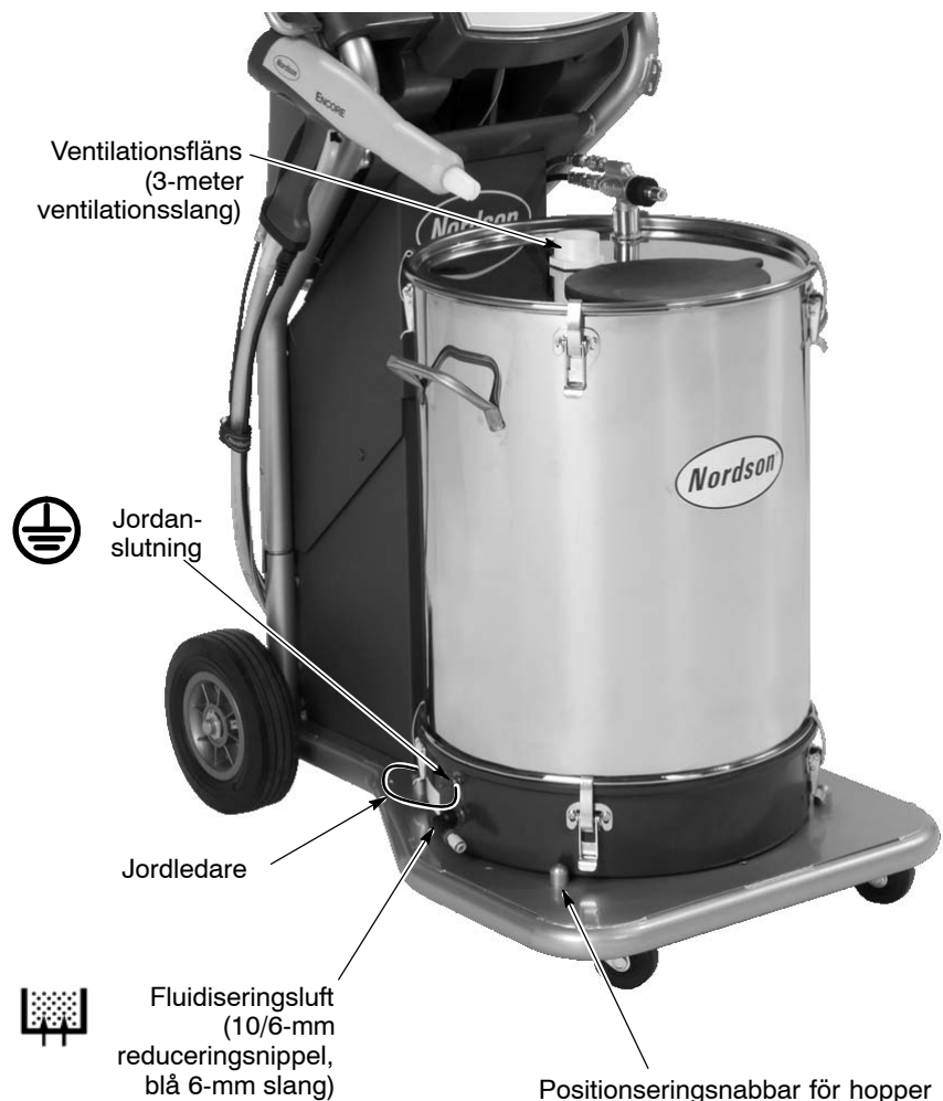
Bild 2-6 Installation av hopper
