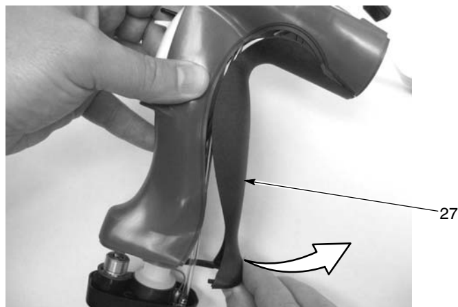
Bild 5-8 Demontering av jordad handtagsdel
