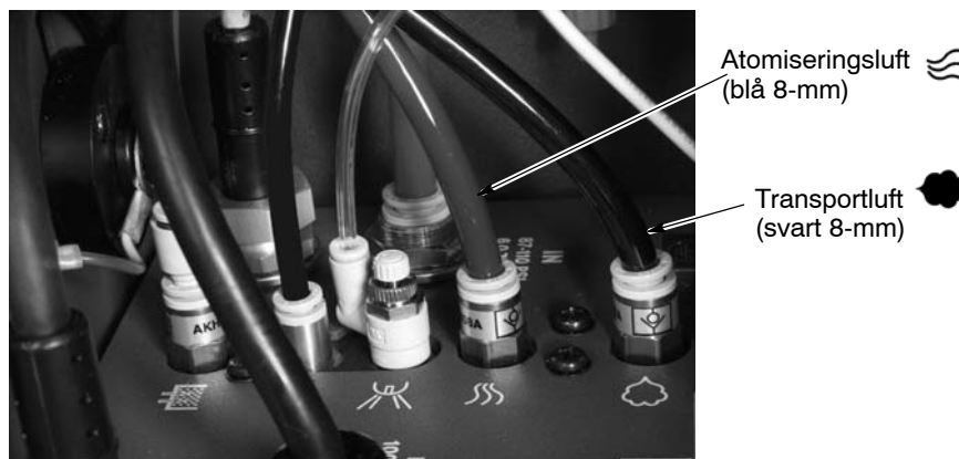
Bild 2-9 Anslutningar för transportluft och atomiseringsluft till kraftdelen
