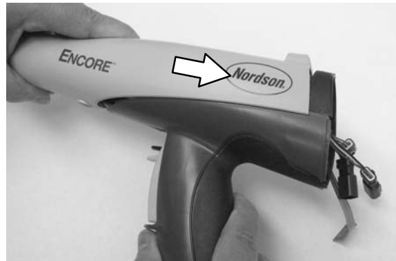
Bild 5-14 Montering av utgångsrör för pulver
