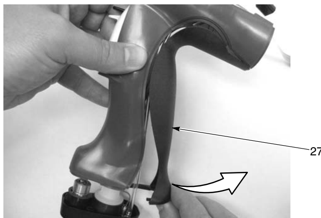
Fig. 5-8 Smontaggio della piattina di messa a terra
