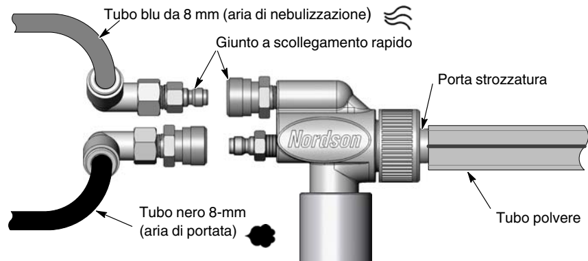
Fig. 2-8 Montaggio della pompa
