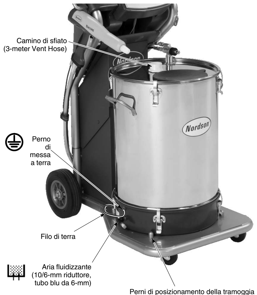
Fig. 2-6 Installazione della tramoggia
