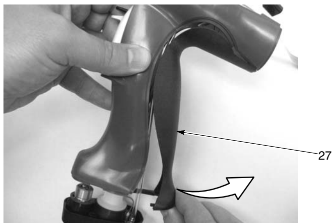
Fig. 5-8 Smontaggio della piattina di messa a terra
