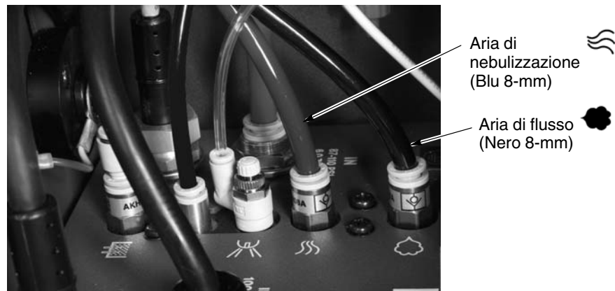
Fig. 2-9 Collegamenti dei tubi dell'aria di nebulizzazione e di flusso alla centralina di alimentazione
