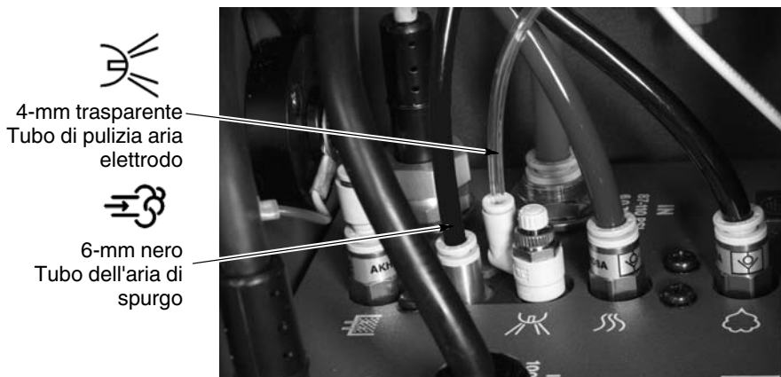
Fig. 2-11 Collegamento dei tubi di pulizia aria elettrodo e aria pistola alla centralina di alimentazione
