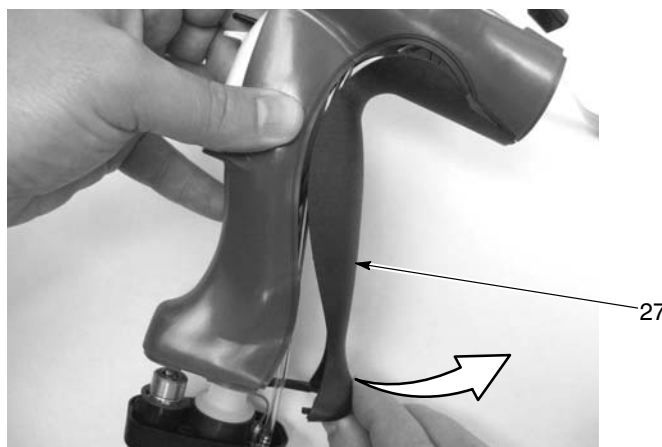
Fig. 5-8 Smontaggio della piattina di messa a terra
