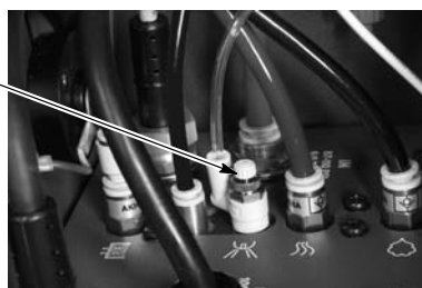
Рис. 3-4 Регулирование воздуха псевдооживления передвижной системы
