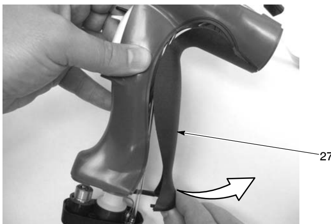
Рис. 5-8 Снятие накладки заземления
