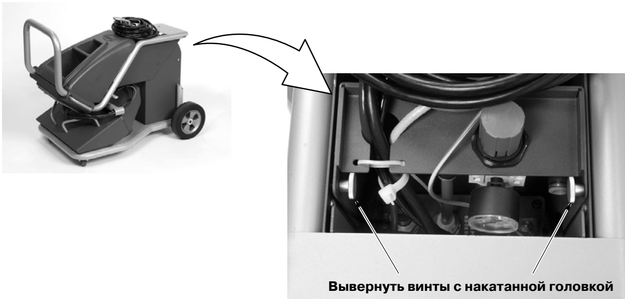
Рис. 2-4 Подготовка к откидыванию рукоятки тележки
