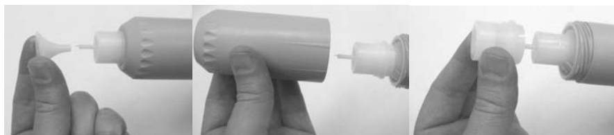
Рис. 3-6 Замена отражателей и конических форсунок
